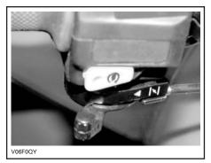
CHOKE LEVER IN THE FULL CHOKE POSITION
